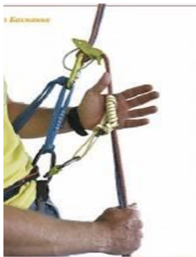
Рисунок 7. Спуск по вертикальным перилам с самостраховкой схватывающим узлом, расположенным ниже спускового устройства
