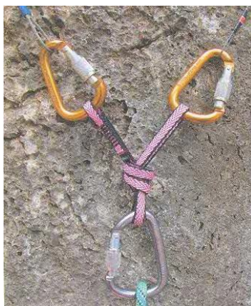
3. Петля, с фиксированным узлом
