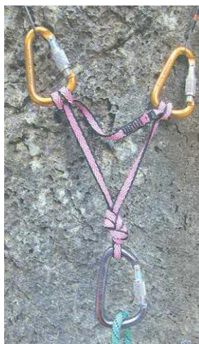
4. Петля, с фиксированным узлом и регулируемой длиной
