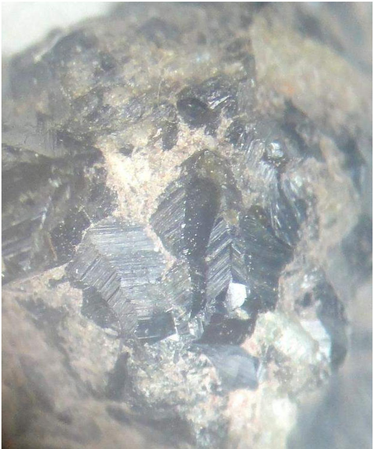
*Рис. 27. Кристаллы касситерита в скарне. Видна штриховка на гранях кристаллов. (МБС-1 оптическое увеличение 16)*
