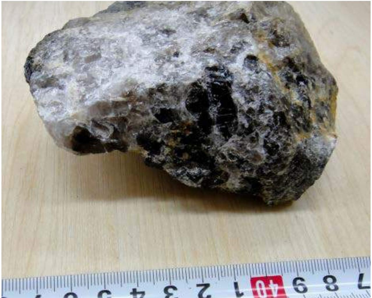
*Рис. 36. Кварцевая жила с кристаллами мориона*
